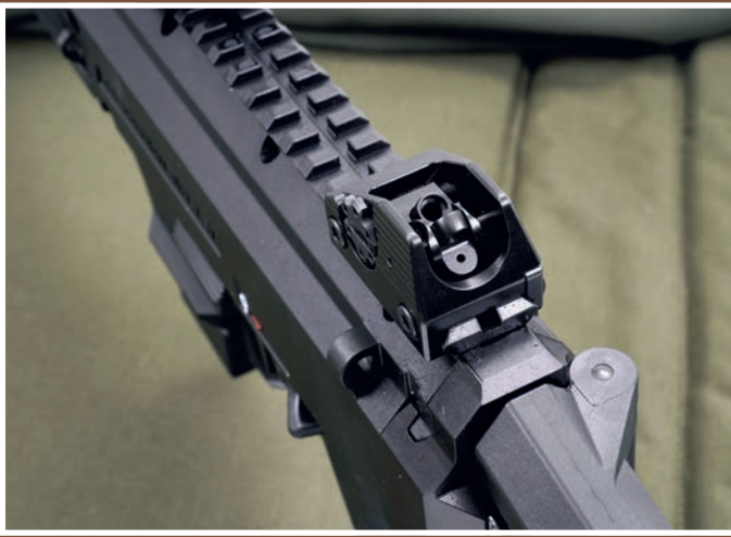
Die mechanische Visierung mit Diopterkimme und Stiftkorn.
